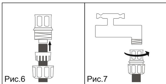
Соедините цанговый зажим (2) с водопроводным краном с наружной резьбой 1/2 (см. рис. 7)
